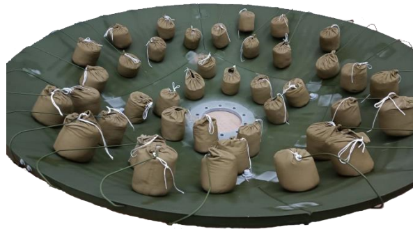
Рисунок 3 – Испытания на воздействие эквивалентной ветровой нагрузки
